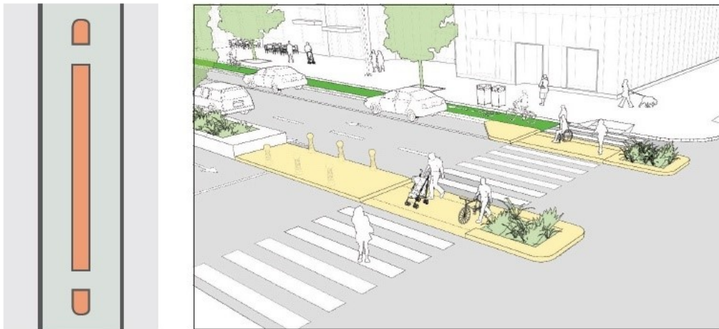
Figura 60 - Possibili interventi di moderazione del traffico - spartitraffico e isole salvagente (fonte: Global Street Design Guide)
