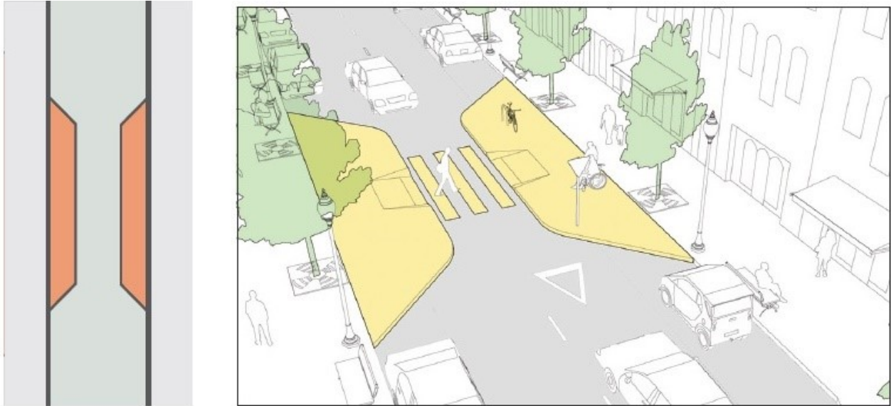
Figura 38 - Possibili interventi di moderazione del traffico - restringimenti e strettoie (fonte: Global Street Design Guide)
