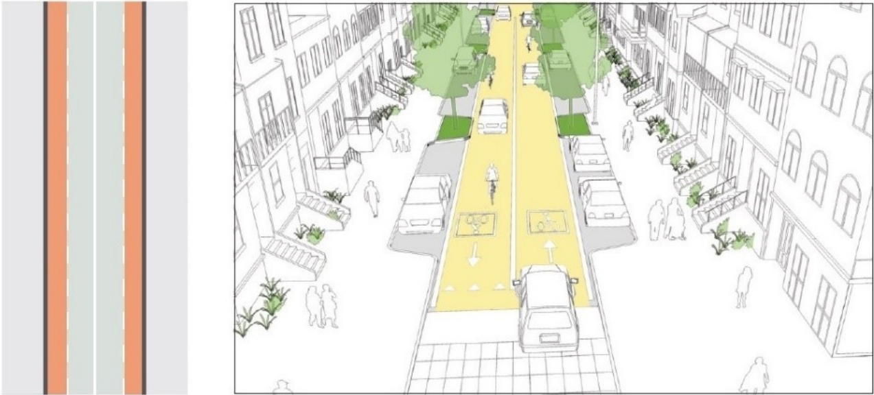
Figura 34 - Possibili interventi di moderazione del traffico - restringimento delle corsie (fonte: Global Street Design Guide)
