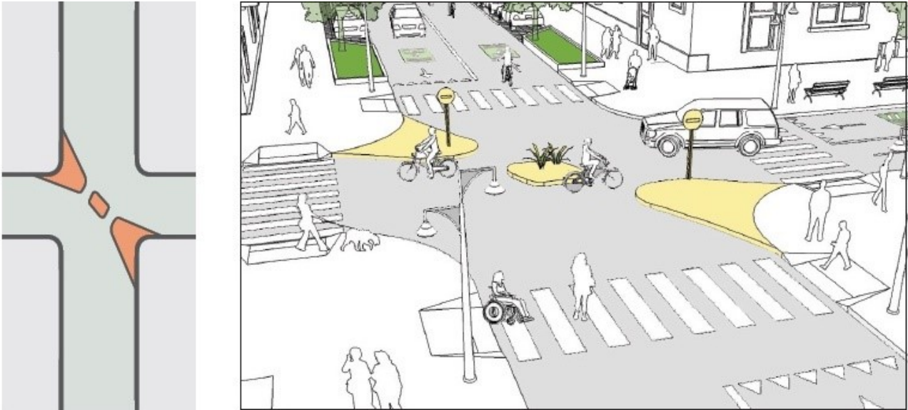
Figura 43 - Possibili interventi di moderazione del traffico - deviatori (fonte: Global Street Design Guide)
