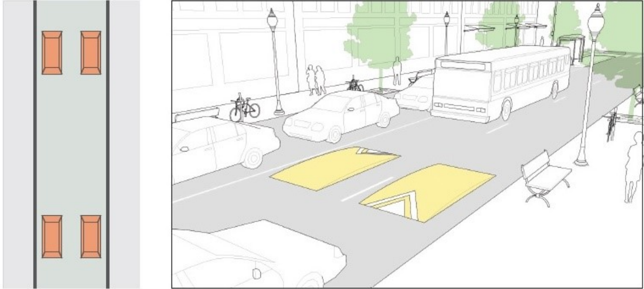
Figura 41 - Possibili interventi di moderazione del traffico - dossi artificiali e i cuscini berlinesi (fonte: Global Street Design Guide)
