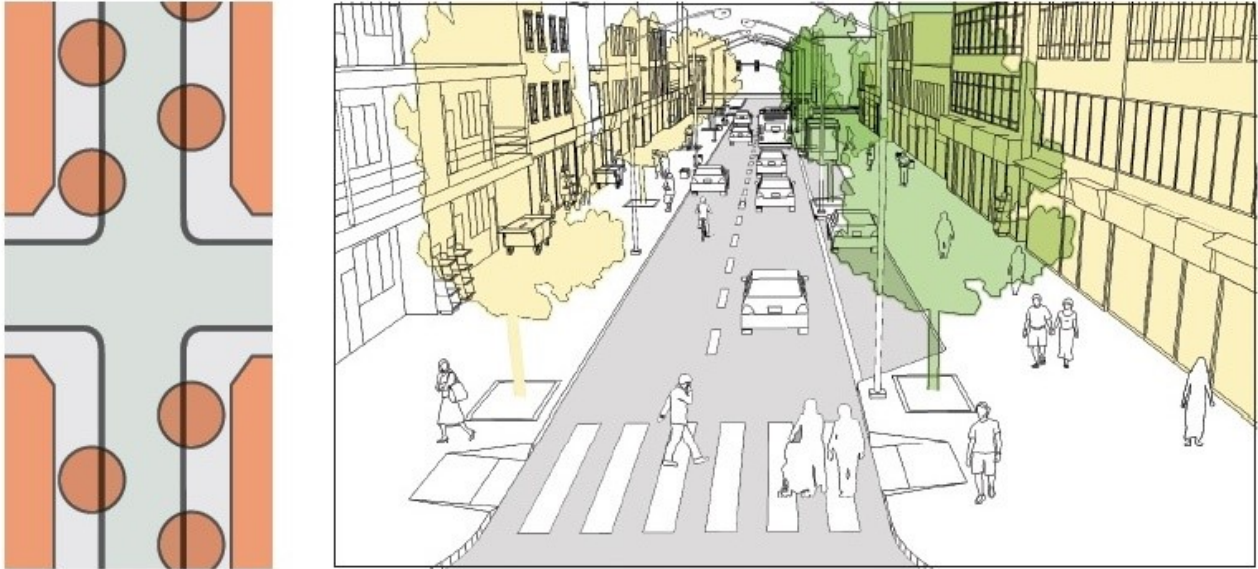
Figura 36 - Possibili interventi di moderazione del traffico - Edifici e alberi (fonte: Global Street Design Guide)
