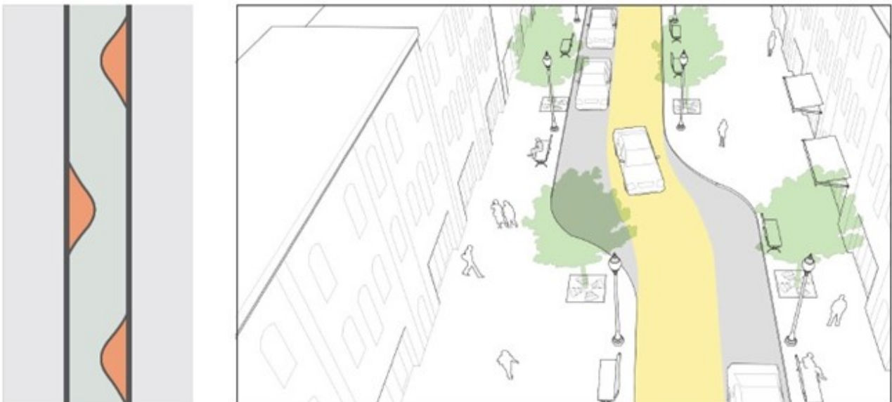
Figura 39 - Possibili interventi di moderazione del traffico - Chicane e disassamenti (fonte: Global Street Design Guide)
