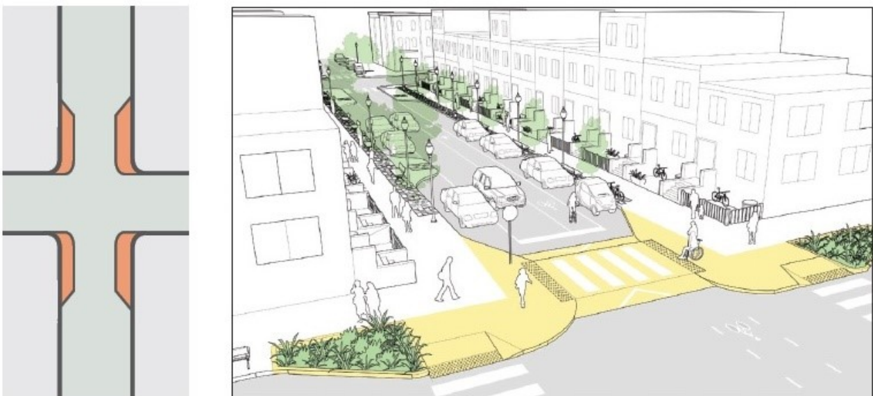
Figura 37 - Possibili interventi di moderazione del traffico - Portali (Gateway) (fonte: Global Street Design Guide)
