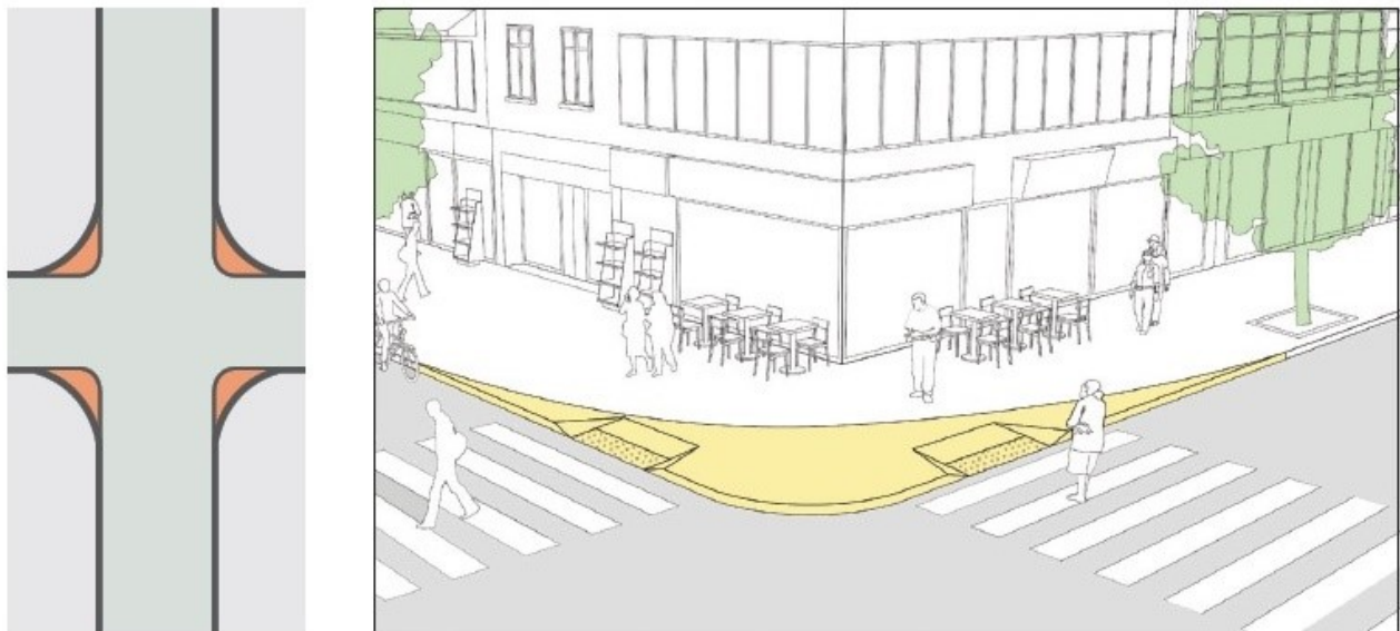
Figura 35 - Possibili interventi di moderazione del traffico - Raggi di curvatura (fonte: Global Street Design Guide)
